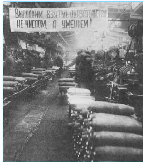
Транспортер потока механической обработки корпуса 122 мм осколочно-фугасного снаряда
