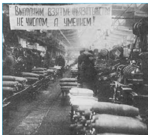
Транспортер потока механической обработки корпуса 122 мм осколочно-фугасного снаряда
