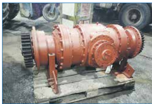
Приобретение редуктора для ремонта грейдера
